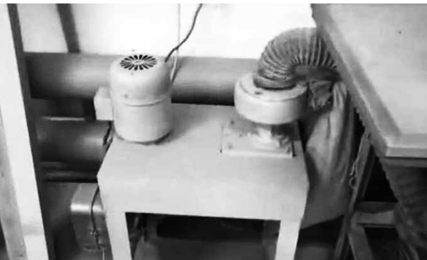
◀ Рис 5. Вытяжка — как важный фактор устройства сто- лярной мастерской
