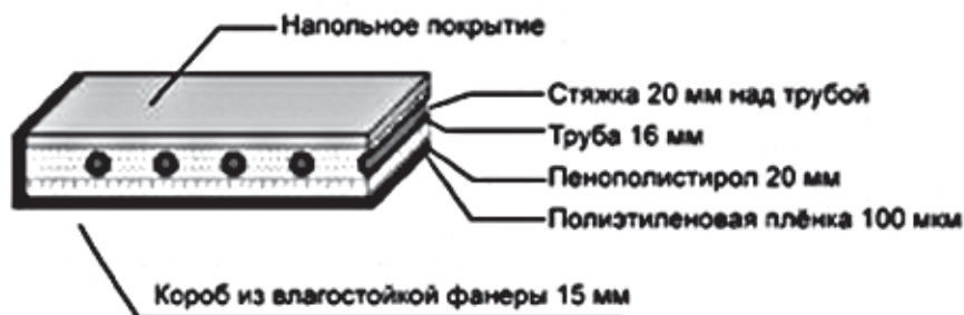
Схема №8. Формирование поверхности при устройстве водяного пола в коробе
