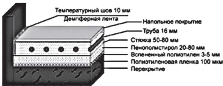
Схема №7. Формирование поверхности при устройстве водяного пола на поверхности
