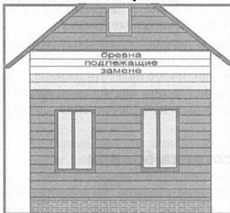
Для доступа к бревнам, требующим замены, необходимо демонтировать обшивку стен фасада ниже заменяемых бревен как минимум на два венца. Если вы планируете полностью сменить обшивку фасада дома, то в этом случае лучше всего полностью демонтировать всю обшивку.
