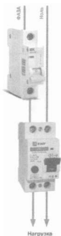
Схема подключения УЗО в однофазной сети
