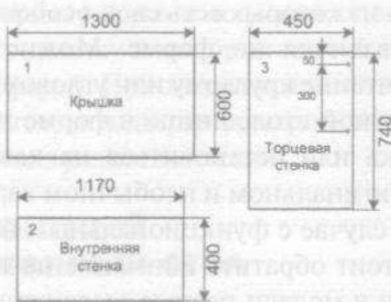
Детали для сборки каркаса письменного стола
